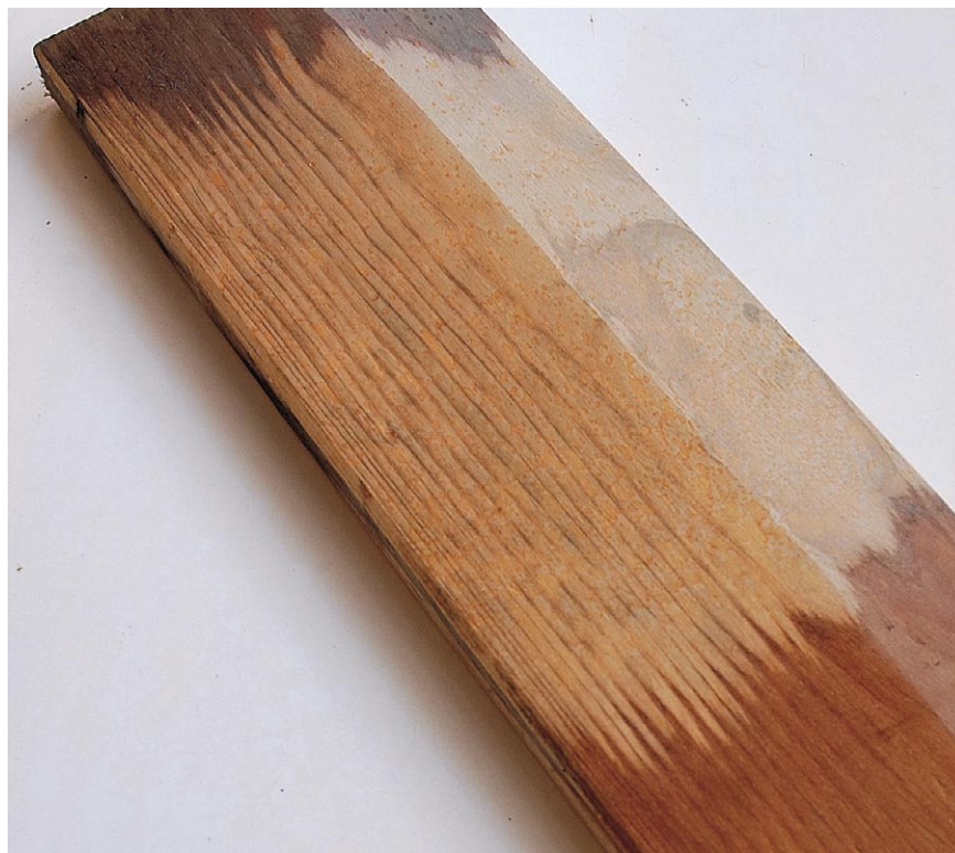
Épicéa raboté : en bas, deux couches de gris, une couche de vieillisseur et une couche d'égalisateur ; en partie supérieure, deux couches de gris. Sur une bande à gauche a été passée une huile pour chalet.
