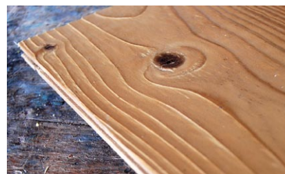
Épicéa brossé en profondeur pour faire ressortir les veines de bois plus dur.
