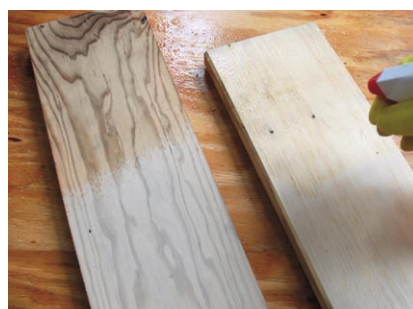
Première couche sur pin maritime (à gauche) et épicéa (à droite).
