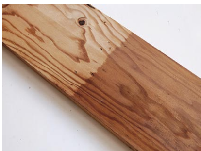
Pin maritime raboté : en bas, deux couches de gris et une couche de vieillisseur.
