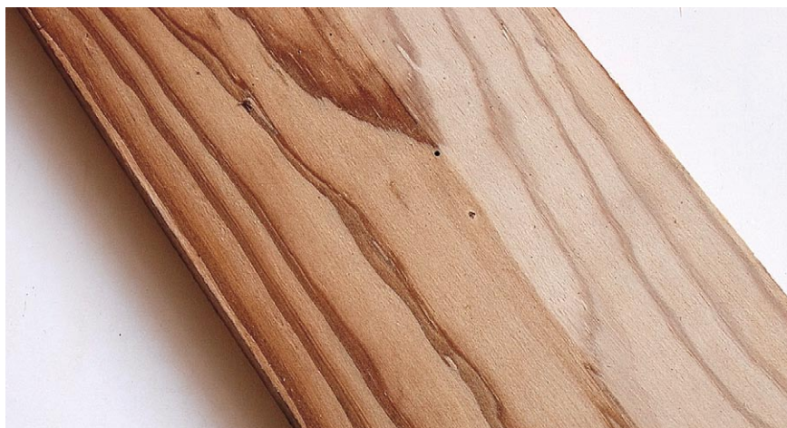
Pin maritime raboté : deux couches de gris, une couche de vieillisseur et une couche d'égalisateur. Sur une bande à gauche a été passée une huile pour chalet.
