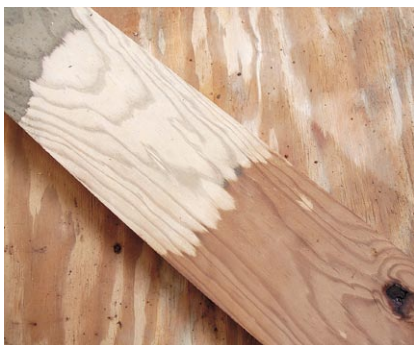
Deuxième couche sur pin maritime raboté ; on remarquera en haut la partie grise de la première couche après séchage.
