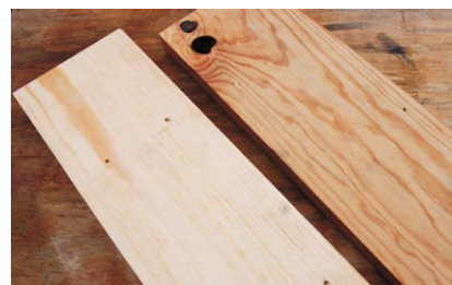
Application de la première couche sur bois rabotés et poncés : épicéa (à gauche) et pin maritime (à droite).
